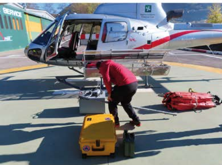
Figura 1 - Imbarco ripetitore elitrasportato con annesso generatore e accessori. Grazie ai ripetitori digitali DMR, la stessa copertura fornita alla fonia viene garantita anche ai dati senza alcuno sforzo aggiuntivo
