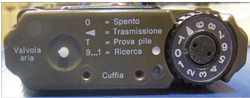
Vista superiore dell'apparato, a destra il selettore di funzione e regolazione sensibilità
